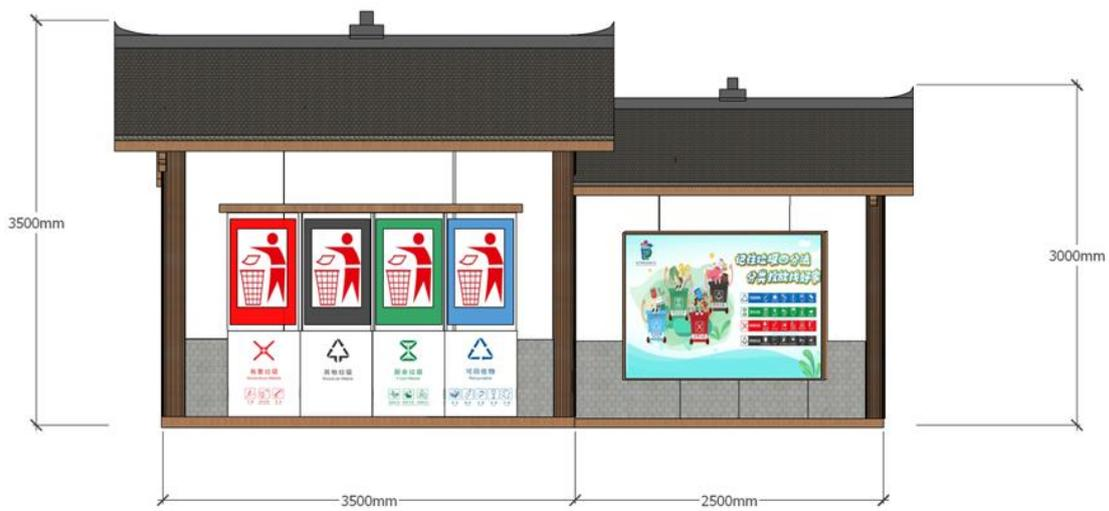
图3-54 样式尺寸图（款式 3）
