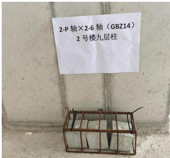
混凝土试件同条件养护
