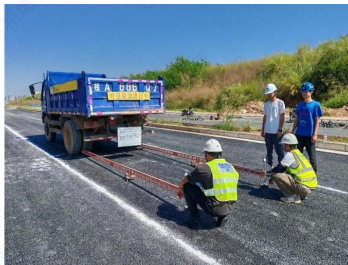
路基路面弯沉检测照片
