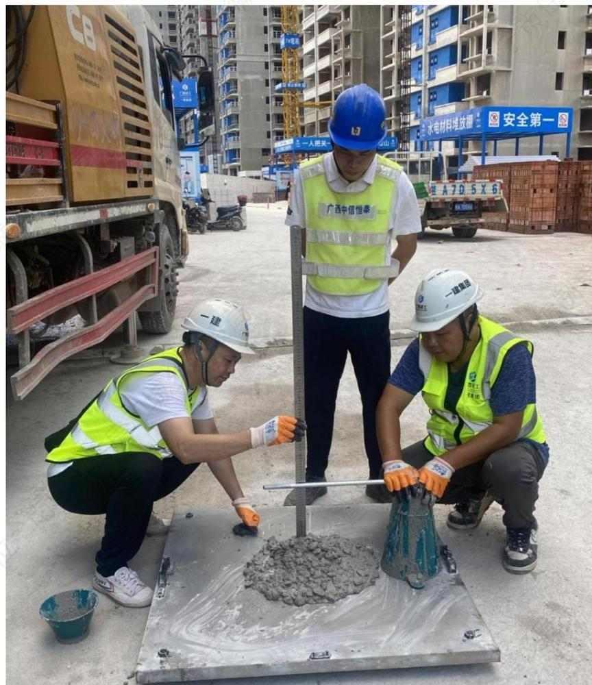
预拌混凝土坍落度检验
