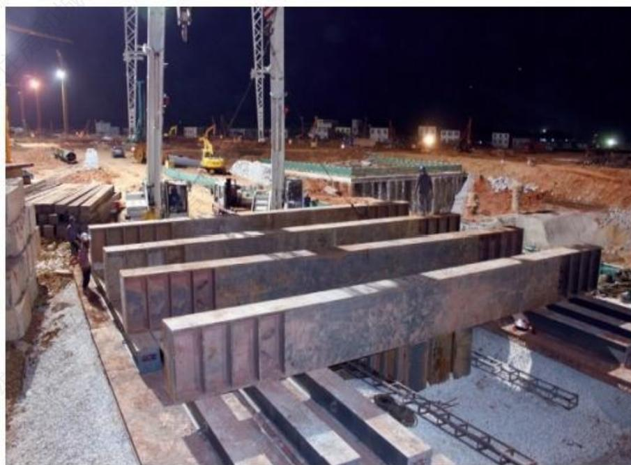
静载加载反力装置
