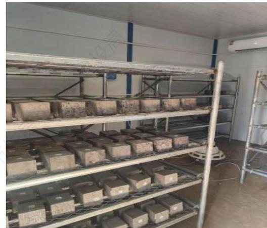
混凝土试件标准养护
